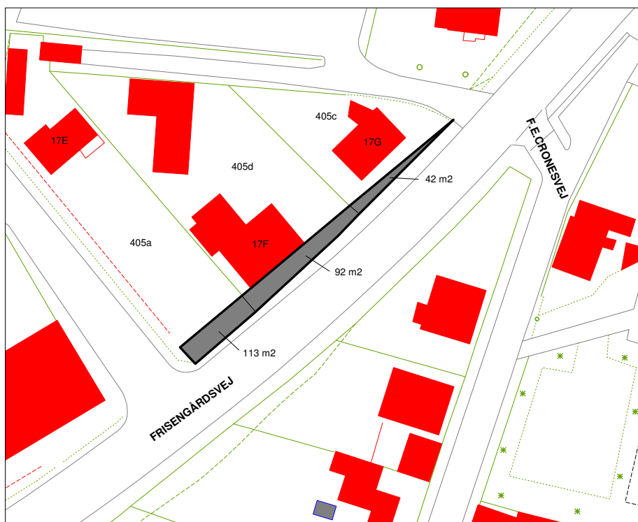
Nødvendigt oversigtsareal, der skal pålægges servitut
