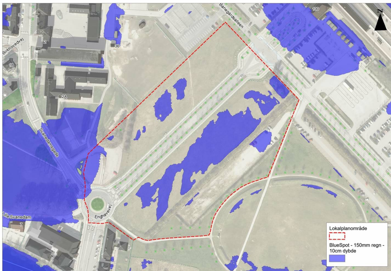
Figur: Områder, hvor der samles vand i tilfælde af kraftige regnskyld (bluespots). Her vist som områder, hvor der står 10 cm vand efter et 150mm regnskyld. En stor del af den sydlige del af planområdet vil være ramt af oversvømmelse i sådan et tilfælde.
