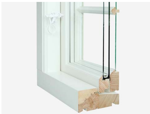
Et koblet vindue består af to vinduesrammer, der er koblet sammen og åbner som ét. Den yderste ramme har tynde, kittede sprosser og er udstyret med enkeltlagsglas – præcis som de originale vinduer fra forrige århundrede. Den inderste ramme kan være et moderne energivindue uden sprosser.
